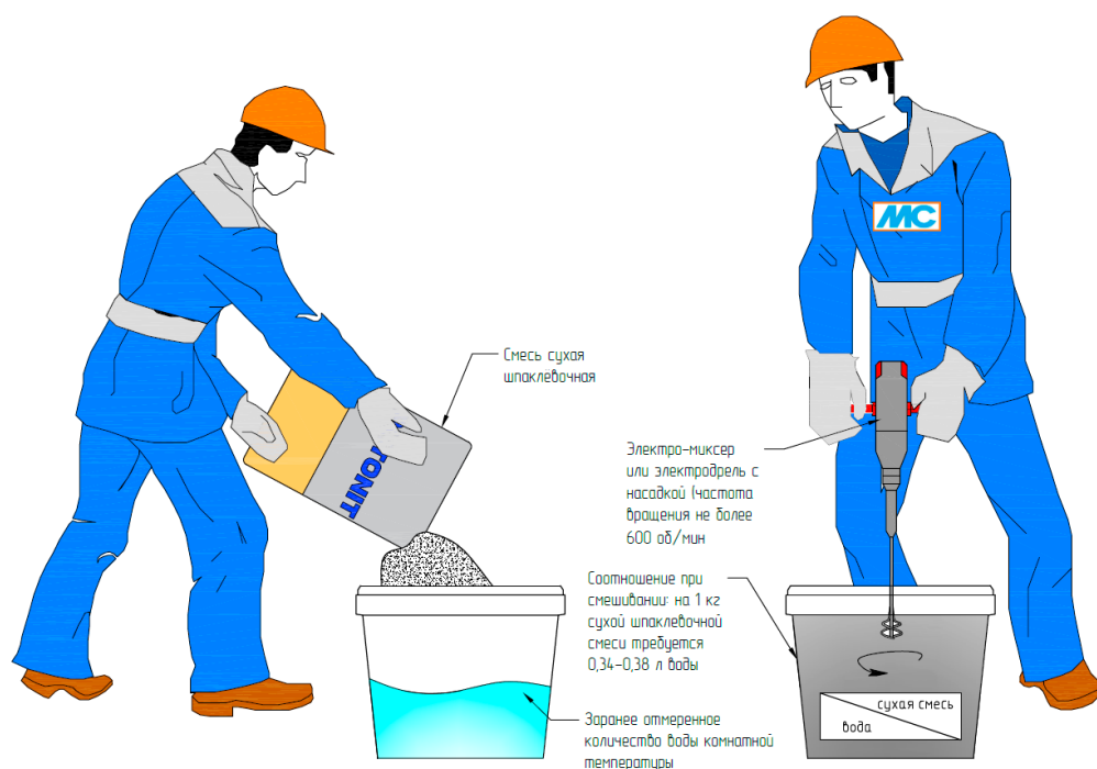
Рис. 16. Организация работ по затворению сухой шпаклевочной смеси
